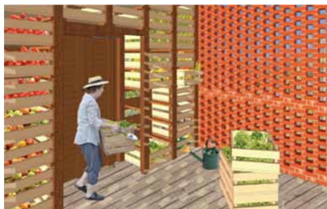
Slika 3: Kažeto sestavljajo stene iz opeke, zložene tako, da v notranjost pronica svetloba in zrak. Ena stena je iz lesenih zabojčkov za shranjevanje sadja in zelenjave (avtorja: Jasmina Filipova, Eva Pepovska, Dimitar Dimoski; predmet: Ekološka načela gradnje).
